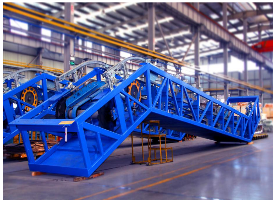
▼ 扶梯骨架 Escalator skeleton
